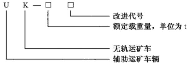
标记示例:额定载重量为 20 t 的地下运矿车:UK—20 地下运矿车。
