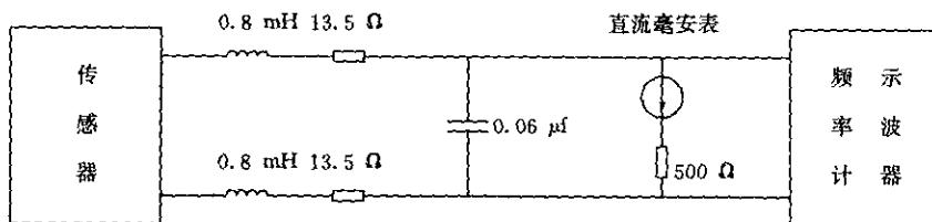
参考电缆规格型号和参数:HUYVR 4×1型矿用阻燃电缆。分布参数: $C < 0.06 \mu\text{F}/\text{km}$ 、 $L < 0.8 \text{ mH}/\text{km}$ 、 $R < 13.5 \Omega/\text{km}$ 。
